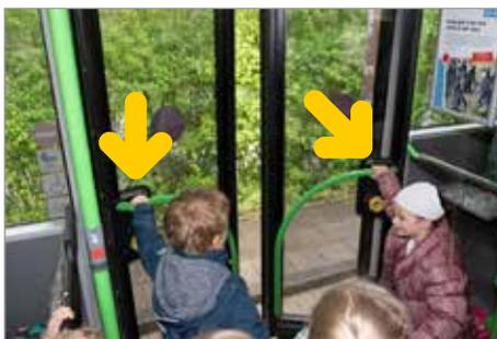
Nach dem Entriegeln, die Türe mit den Händen öffnen.
